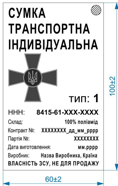
Рисунок 2 – Зовнішній вигляд товарного ярлика та його розміри
