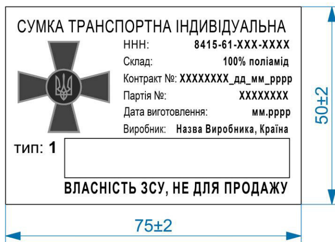
Рисунок 1 – Зовнішній вигляд етикетки та її розміри
