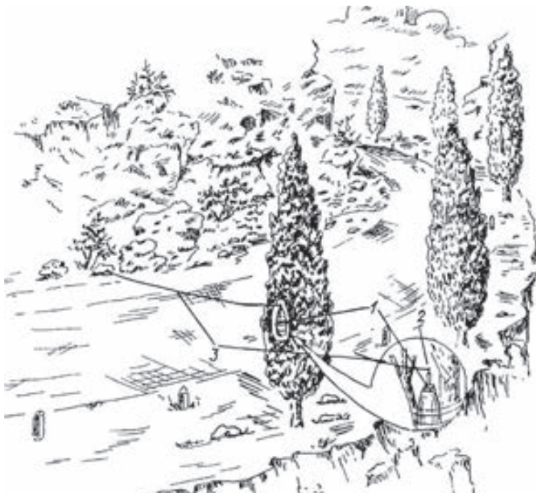
Рис. 2. Установка фугаса на дереве
