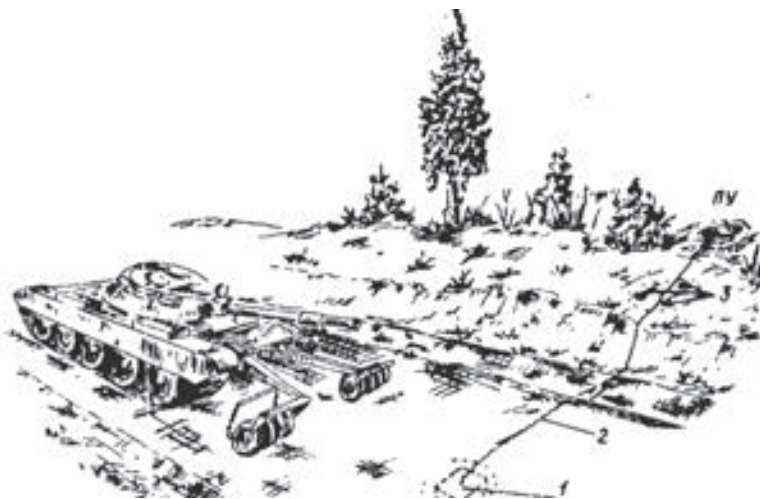
Рис. 3. Управляемый фугас в межколейном пространстве: 1 — заряд ВВ; 2 — линия управления фугасом; 3 — мина ПМН
