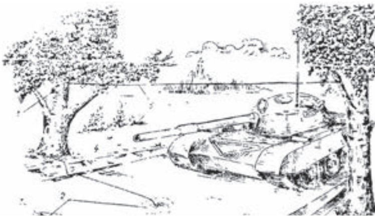
Рис. 2. Комбинированный фугас на дороге: 1 — мина МОН-50; 2 — артиллерийские снаряды; 3 — заряд ВВ; 4 — детонирующий шнур; 5 — растяжка
