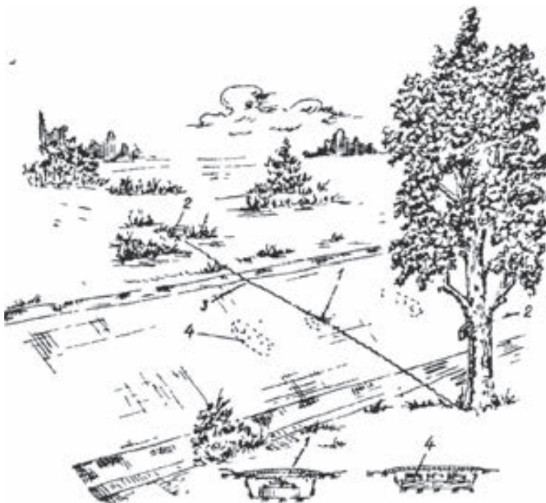
Рис. 4. Комбинированный фугас: 1 — заряд ВВ (10 — 25 кг); 2 — мина МОН-50; 3 — детонирующий шнур; 4 — мина ПМН
