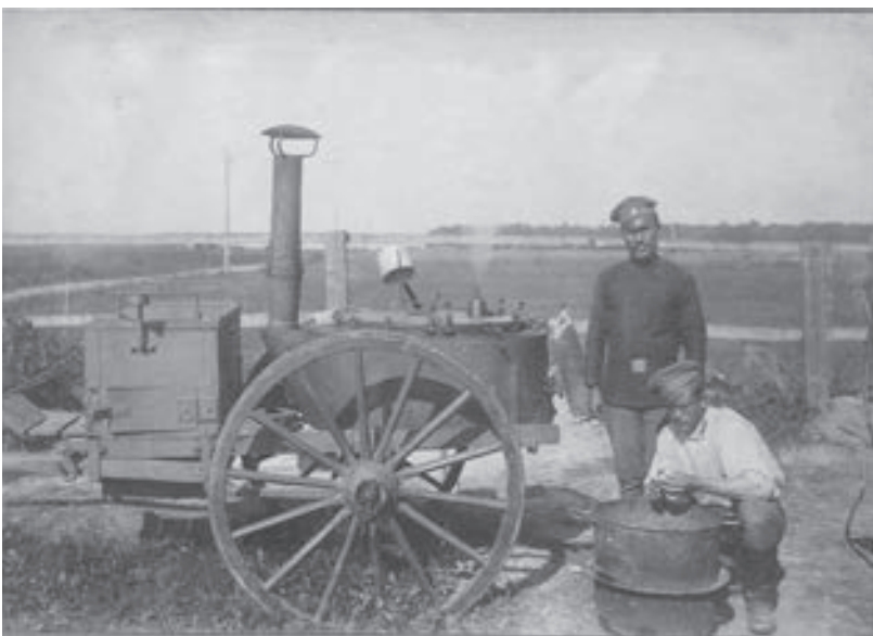
Рис. 1. Походная кухня А.Ф. Турчановича. Благодаря ей русская армия стала более подвижной, пищу можно было готовить прямо в походе и на марше
