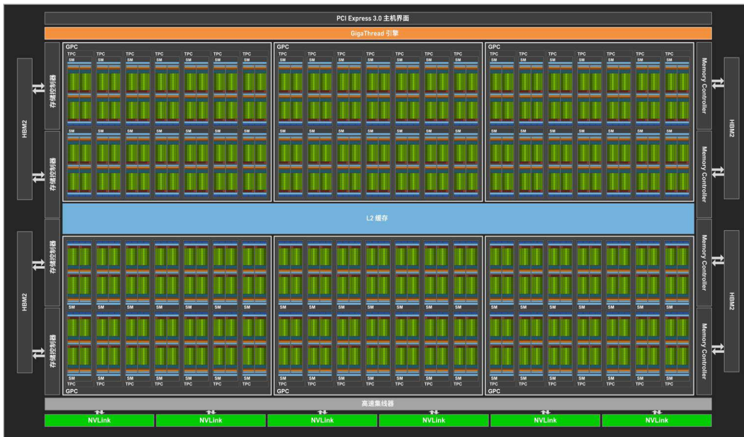
图 4. 含 84 个 SM 单元的完整 Volta GV100 GPU
