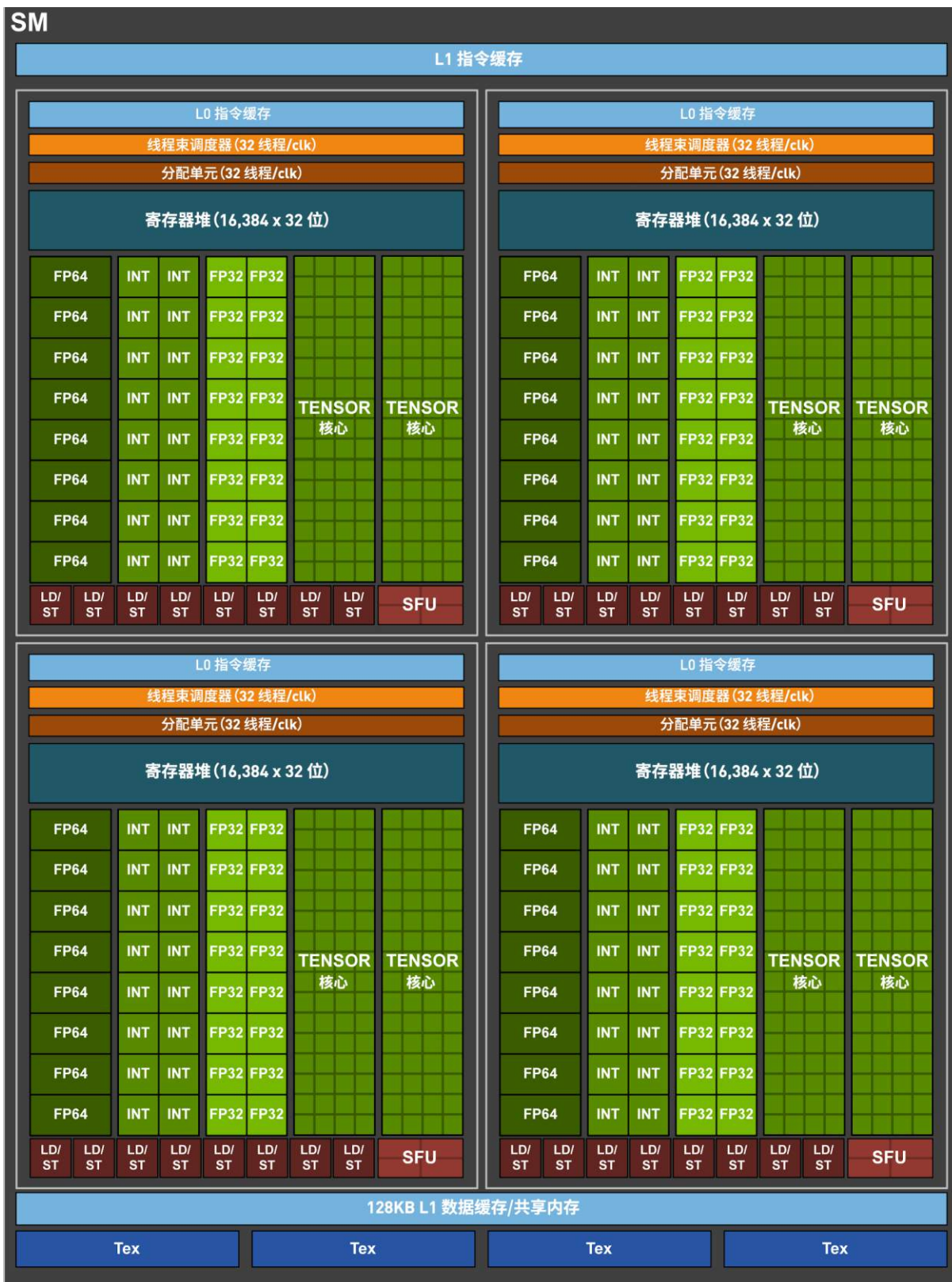
图 5. Volta GV100 流多处理器 (SM)
